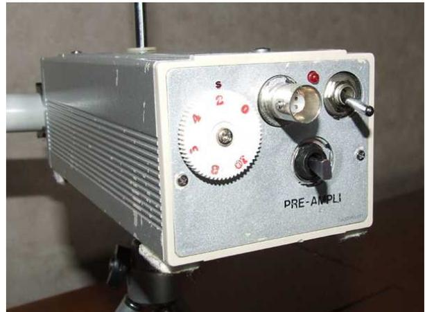
Foto n°6: Il fondello dell'antenna con i controlli
