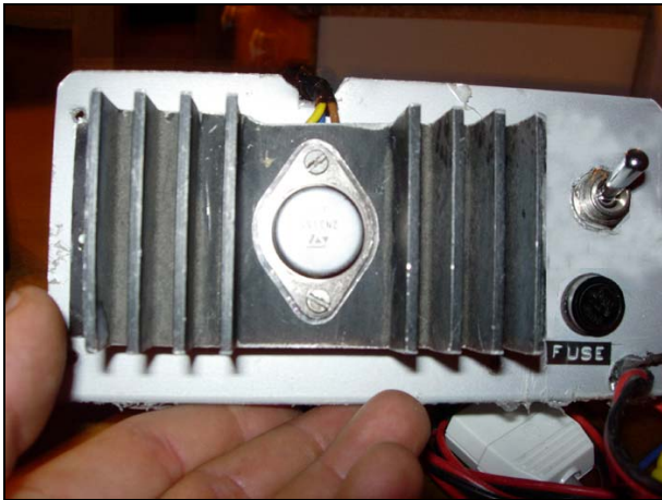
Il retro con il regolatore di potenza
