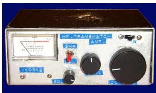
In questo caso l'accordatore toglie agevolmente quel pelo (!) di disadattamento, facendo dare al TX sempre il meglio : al limite va bene un filo generico da impianto elettrico di almeno 10 metri, perché misure più corte hanno solo l'effetto di dissipare e scaldare la bobina interna senza o quasi resa effettiva.
