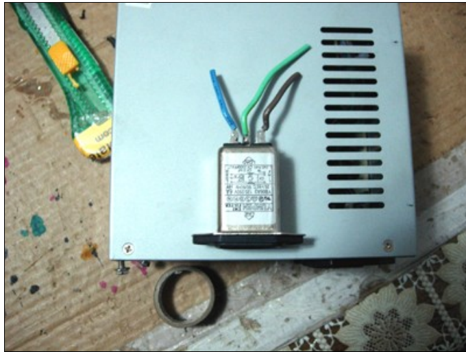
Il filtro prima del montaggio
