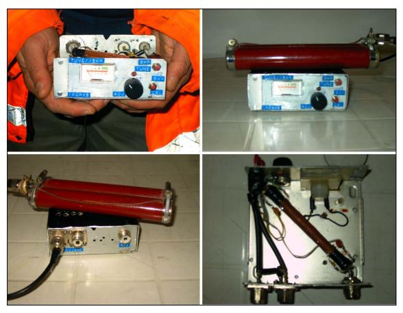
La sonda del rosmetro è ricavata da uno spezzone di cavo RG-58 , in cui sotto pelle vengono inseriti due link ( o conduttori paralleli al file centrale ) che sono poi isolati dalla calza esterna che funziona da schermo complessivo.
