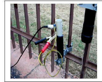
Il fissaggio del balun con una staffa
