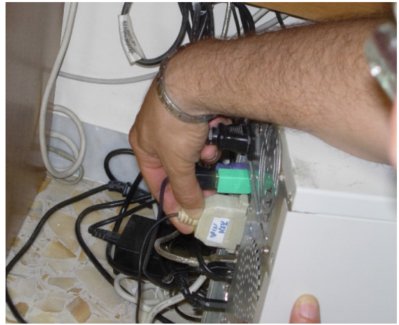
Ancoraggio del plug sulla porta parallela del PC fisso
