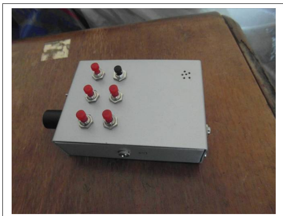
Fig 7: Si noti la foratura sul coperchio per il cicalino
