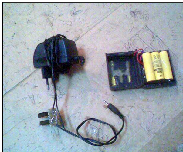
il pacco delle batterie
