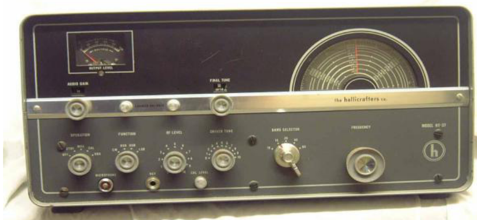
foto 13 : Hallicrafters HT 37 con generatore SSB a "sfasamento"
